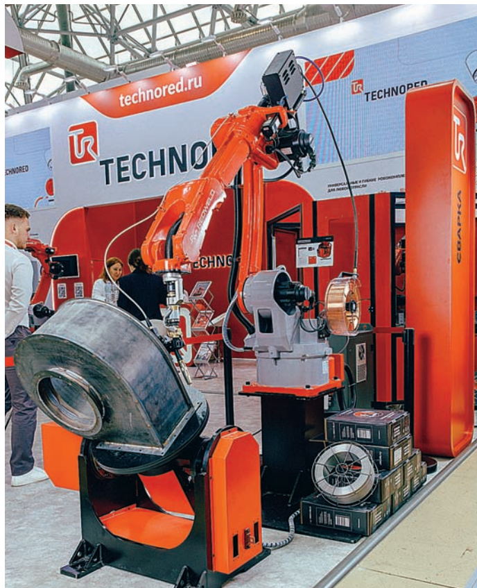
Сварочная система Redweld 2000-6axis MIG на базе двухметрового робота позволяет обрабатывать габаритные детали, а благодаря позиционеру с двумя осями решение становится более функциональным и может сваривать детали с разным пространственным положением швов
