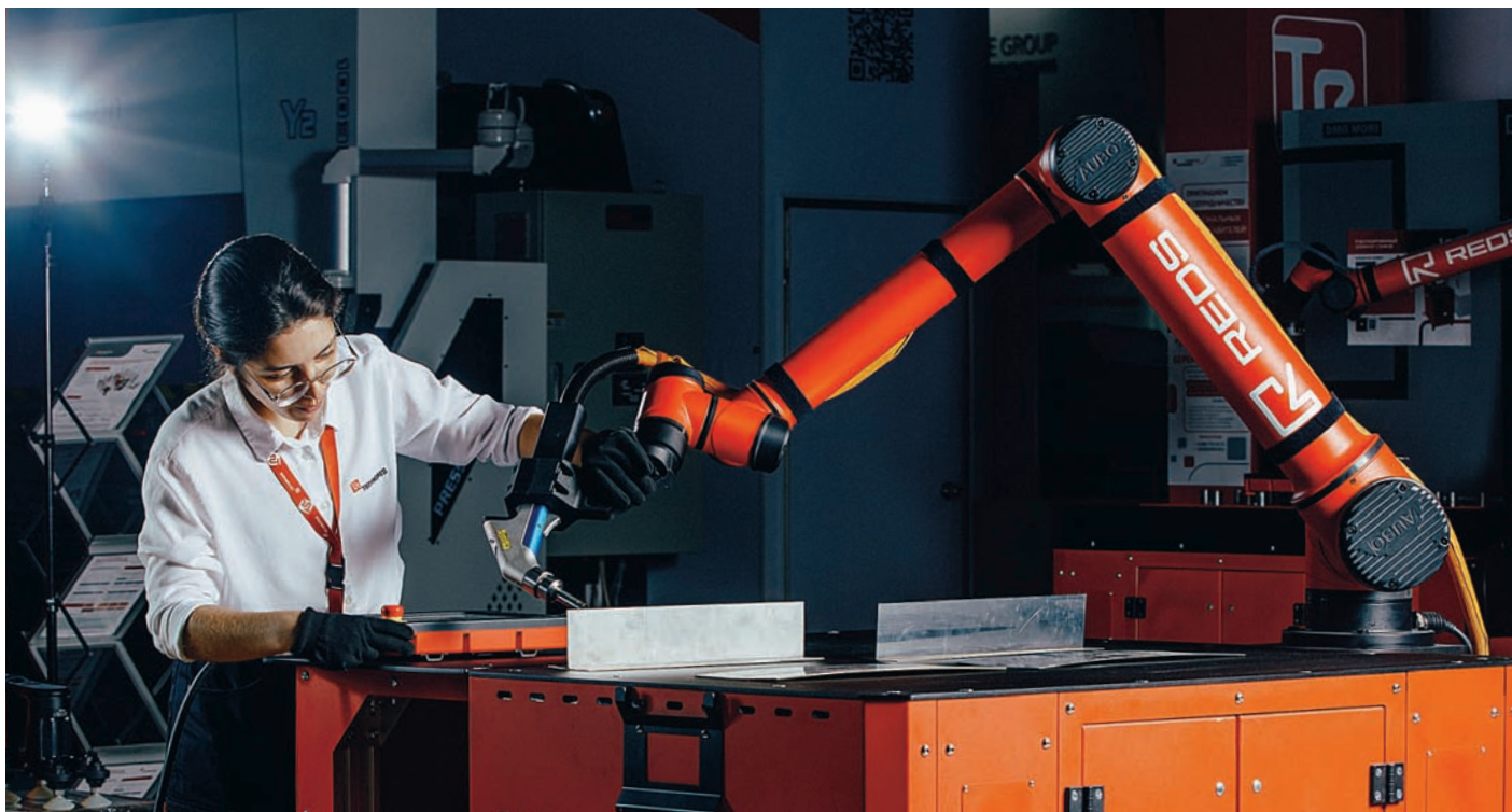
Внедрение на производстве универсальной роботизированной сварочной системы Redweld Pro 10 Cobot Laser занимает до трех дней. Быстрая и простая переналадка под задачи происходит за счет интуитивно понятного интерфейса
